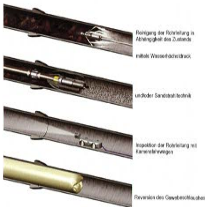
Bild 4: Übliche Verfahrensschritte für das Gewebeschlauchrelining von Versorgungsleitungen
