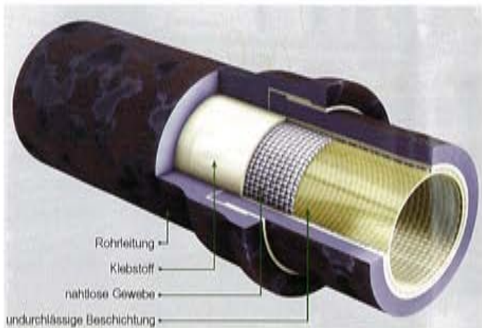
Bild 3: Verbundsystem bestehend aus mit der Rohrwand vollflächig und hinterwandungsdicht verklebtem Gewebeschlauch
