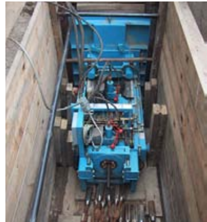
Abb. 2 Kompakte hydros®PLUS-Anlage mit 850 kN Zugkraft
